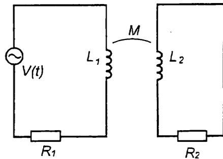
コイル1には起電力  $V(t)$  の交流電源および抵抗値  $R_1$  の抵抗がつながれており, コイル2には抵抗値  $R_2$  の抵抗のみがつながれている。コイル1と2の自己インダクタンスをそれぞれ  $L_1, L_2$ , コイル1と2の間の相互インダクタンスを  $M$  とおく。
